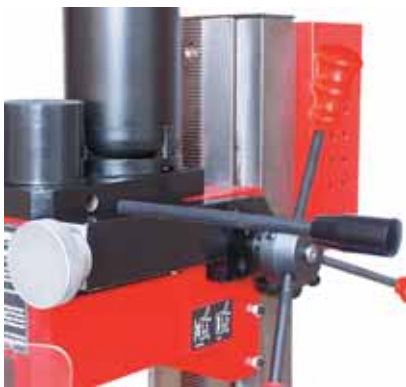
Fixieren der Arbeitsspindel mit Hilfe der Fixierstange
