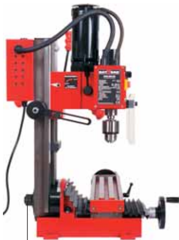
Befestigungsmutter zum Verstellen der Fräskopfneigung
