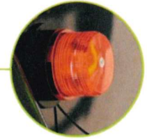
Rundumleuchte zur besseren Wahrnehmung
